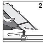
2 Druhou dlaždici shora zarovnejte a přiklepněte paličkou. Vyrovnané koncové spoje znamenají, že dlaždice se správně spojily. Dbejte na to, aby byly přesně zarovnané a aby byla použita distanční tělíska pro vytvoření dilatačního prostoru.
