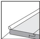
Dilatační mezeru lze zakrýt připevněním lišty.
