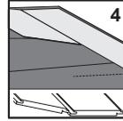
4 Chcete-li začít druhou řadu, seřízněte dlaždici na požadovanou délku, přiložte jazýček nové dlaždice pod úhlem do drážky a pohybem dolů dlaždici umístěte do polohy, zachovejte přitom vyobrazené uspořádání.
