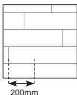
Efekt dřeva: Dlaždice pokládejte s náhodnými šikmými spoji o minimální vzdálenosti 200 mm mezi krátkými konci.
