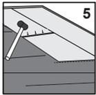
5 Další dlaždici zasuňte pod úhlem, nechte ji těsně dotýkat předchozí dlaždici v řádce a pohybem dolů dlaždici umístěte do polohy. Koncový spoj důkladně přiklepněte gumovou paličkou, aby se zajistil.
