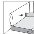
Pro zakrytí dilatační mezery lze použít soklovou lištu a zárubně lze před instalací podříznout do správné hloubky, aby povrch čistě splýval.
