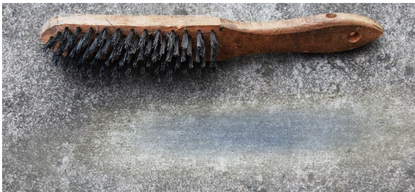
Správně provedená zkouška ocelovým kartáčem
